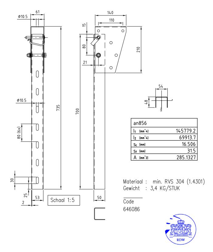
dikte tolerantie +/-0.25 mm maattolerantie +/- 3 mm.
